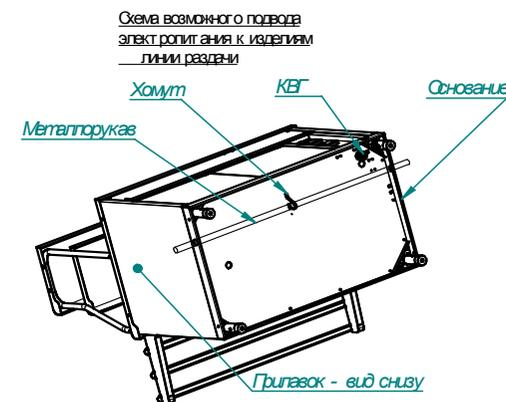
В основаниях изделий линии раздачи введено сквозное отверстие диаметром 29,5 мм и поддерживающие хомуты для возможности и проведения металлорукава с питающими кабелями сквозь все изделия линии раздачи.
