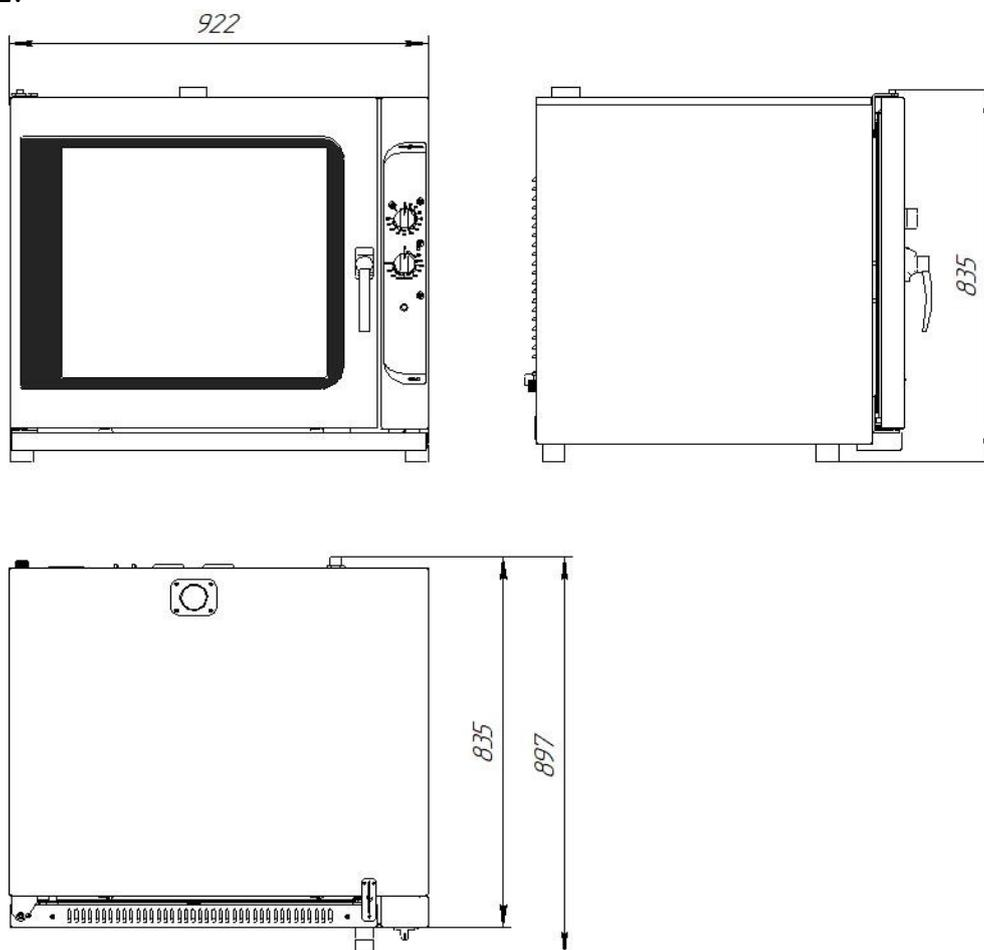
Рис.1 Общий вид печи конвекционной ПК-М-6-400/600.
