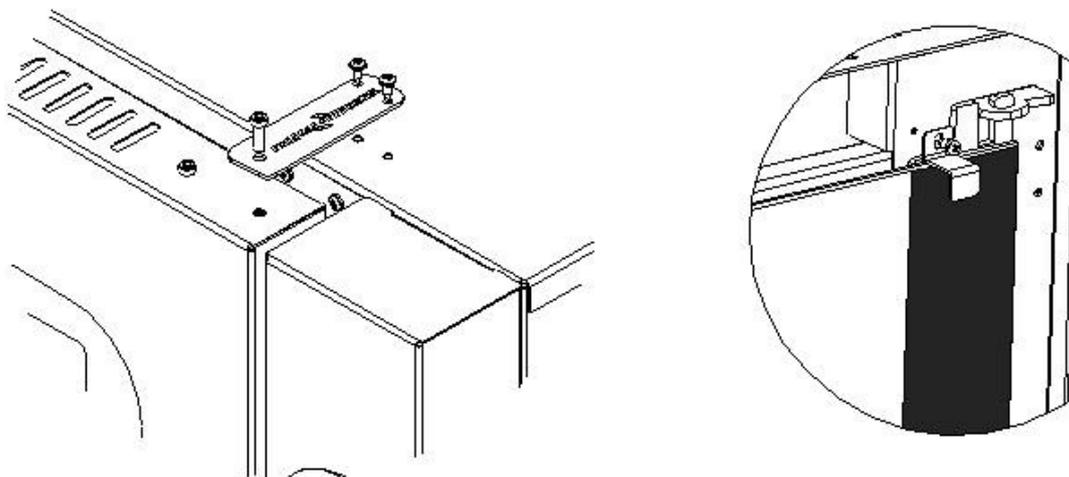
Рис.6 Транспортные крепления на двери ПР-04М, ПР-06М, ПР-10М.
