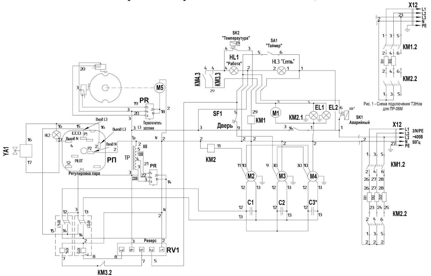
Рис. 1 - Схема подключения ТЭНов для ПР-06М
