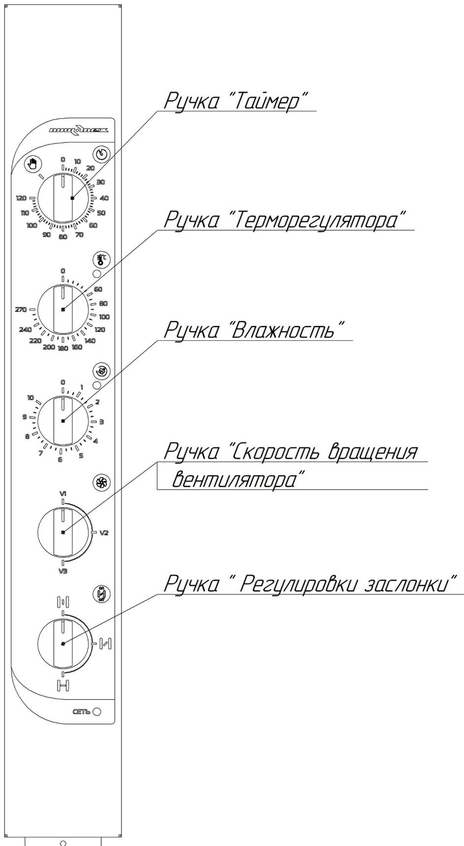
Рис.5 Внешний вид панели управления ПР-04М, ПР-06М, ПР-10М.
